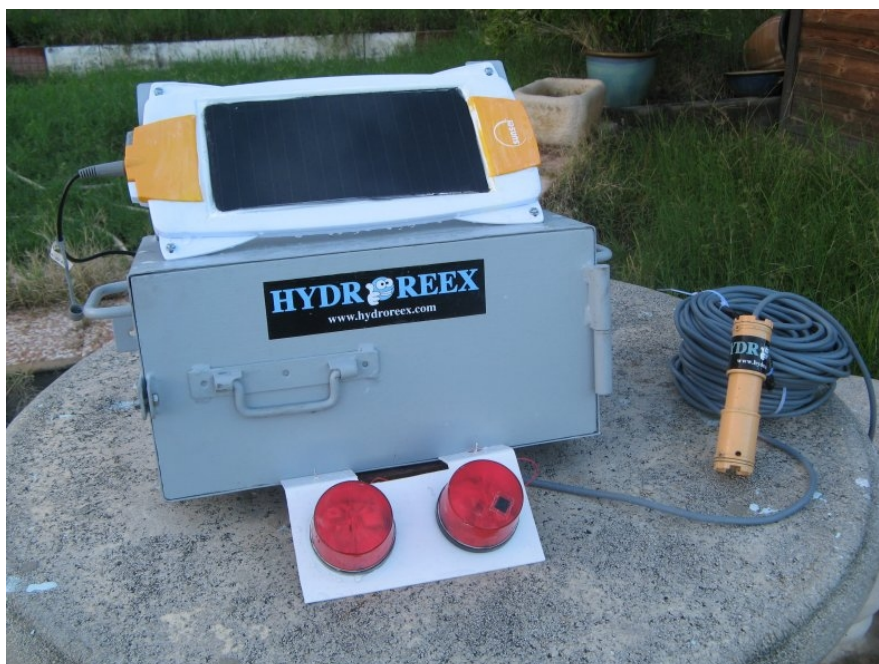
La station HR-VIGIRADIER (configuration avec double flash clignotant temporisé programmable)
